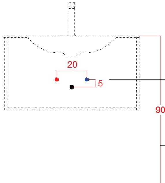
Distance entre les charges et le drainage de l'eau
